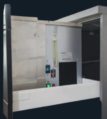
APERTURA LATO DX THERMOSTATI FREDDA E CALDA E LIVELLO BANCO DI GHIACCIO
