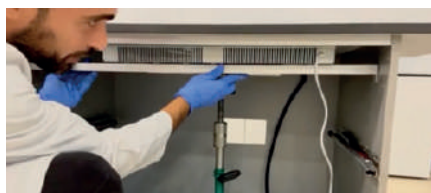
Sistemare e avvitare le barre metalliche sotto al sistema. Place and screw the metal bars under the system.
