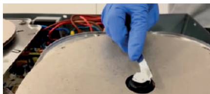
Applicare la pasta termica sui sensori del sistema. Apply the conductive thermal paste on the sensor.
